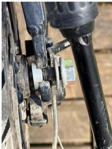
Le méplat de l'axe fileté se glisse dans la fourche d'accueil. La rondelle la plus près de la roue possède une excroissance qui se loge dans l'ouverture de la fourche. La rondelle normale est derrière l'écrou.
