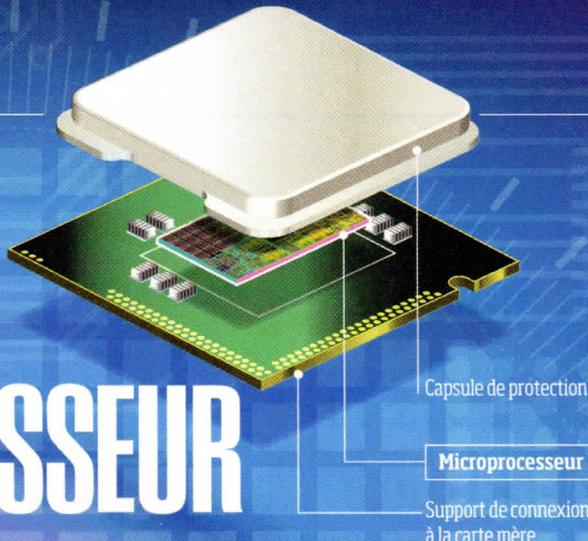
De plus en plus puissant et de plus en plus petit, le microprocesseur est au cœur de votre PC : il calcule tout ! Composé de millions de transistors, son processus de fabrication est à la pointe des hautes technologies. Réalisé et testé en salle blanche, le zéro faute est de rigueur. Voici les principales étapes.
